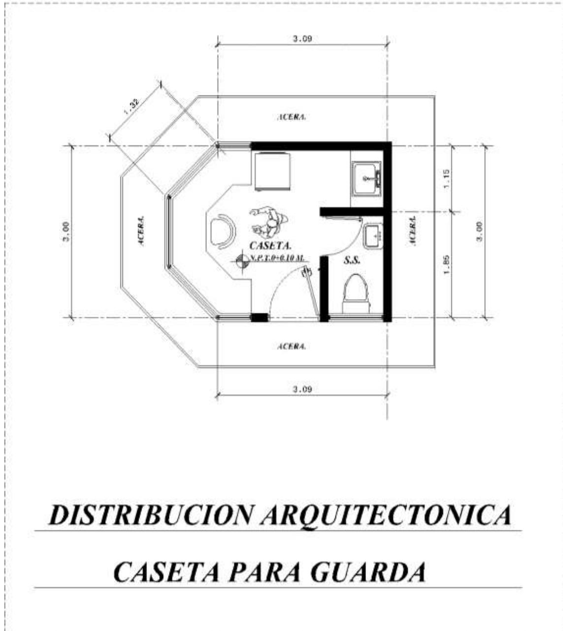
*Figura 44. Distribución arquitectónica de Caseta de Seguridad*
