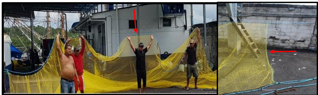
Figura 5. Red experimental 1 mostrando la relinga superior (izquierda) y el calón o mecate que une la relinga inferior con la superior (derecha).
