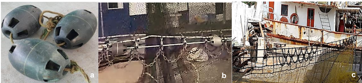
Figura 7: Algunos detalles de la red utilizada en la pesca de camarón fidel. (a) Tipo de rodines utilizados y (b) Su ubicación en las redes experimentales; (c) Cadena trameada.
