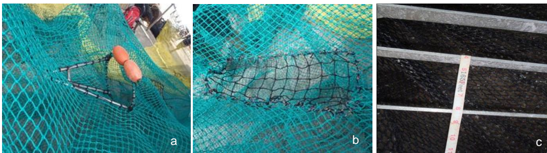
Figura 4a: Algunos aditamentos utilizados en las redes experimentales. a) Estructura del dispositivo de exclusión de peces tipo "ojo de pescado", b) Panel de malla cuadrada usado en las cuatro redes experimentales y c) DET con abertura entre rejillas de 4 pulgadas para las redes en los experimentos 1 y 4.
