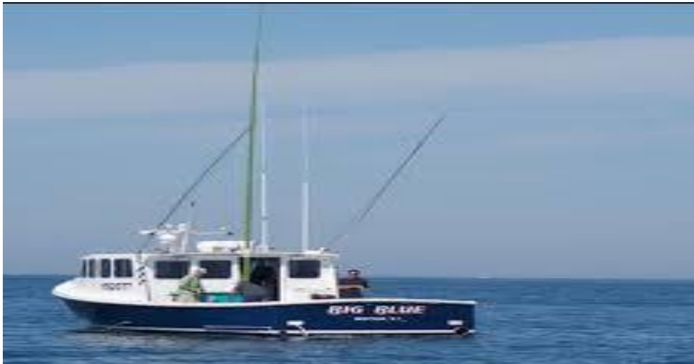
Figura 4. Caña o palo verde que se instala apoyado en una estructura situada en el centro de la embarcación.
